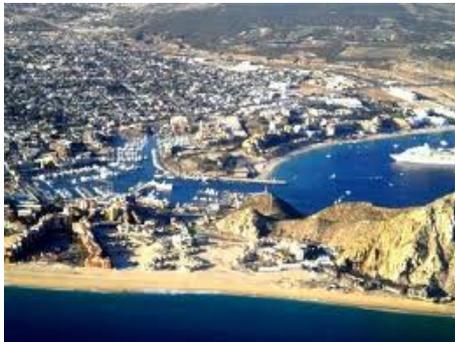
Es un puerto artificial protegido por dos escolleras que definen la entrada a la dársena, construido en el año de 1973, el canal de acceso tiene 50 m de anchura.
