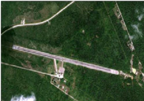
En Mahahual no existe aeropuerto, sin embargo al Norte, en latitud  $18^{\circ} 45' N$  y longitud  $87^{\circ} 41'W$ , se encuentra un aeródromo con pista de asfalto con terracería compacta y capa de petróleo, con una longitud de 1200 metros de largo y 25 metros de ancho, franja de seguridad de 80 metros, plataforma de 60 x 60 metros, elevación de 2 metros sobre el nivel del mar, operado por la empresa VIPSAESA.
