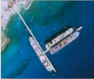
En la Costa Maya, en latitud  $18^{\circ}43'58''N$  y longitud  $87^{\circ}41'31''W$ ; se localiza el muelle turístico de Mahahual, esta estructura tiene forma de "Y", es de concreto premezclado, con una profundidad máxima en el brazo Este de 14 metros, no cuenta con servicios para abastecimiento de combustible, agua potable o aguas negras. Tiene alumbrado público y pueden atracar hasta tres cruceros turísticos de 366 metros de eslora, no cuenta con servicio de remolcadores.
