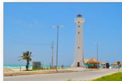
La ayuda a la navegación en Banco Chinchorro es el faro de Cayo Norte, situado en latitud 18° 45.4" N y longitud 087° 2.7"W, esta construcción de concreto de forma tronco cilíndrica, de 12 metros de altura es de color blanco, su característica luminosa es de 1 destello cada 60 segundos y el alcance geográfico es de 8 millas náuticas
