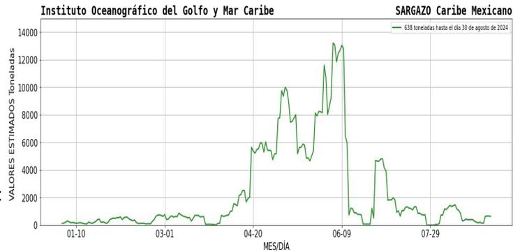
**Figura 1-** Densidad de sargazo calculada como una media de los 7 días anteriores (incluido el día actual), basada en las imágenes correspondientes del Índice Alternativo de Algas Flotantes (AFAI) utilizando el método descrito en Wang y Hu (2016). Valores estimados del **01 de enero al 30 de agosto** del presente año, obtenidos a partir de datos de la USF.
