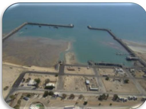
En inmediaciones de la escollera sur del Puerto en la entrada de la dársena está ligeramente azolvada por la parte exterior, formando un bajo de arena que corre del centro del canal de navegación al sur, por lo que los buques deben entrar cargados a la escollera norte; El interior de la dársena del Puerto se encuentra azolvado en un 50% de área total. Con marea baja los azolve se puede observar a simple vista.
