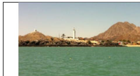
Baliza de enfilación posterior:- En situación geográfica Lat:- 31° 02' N, Long:- 114° 49' W, torre troncopiramidal de aluminio de 10.30 m de altura con características luminosas DB en un periodo de 2.0 seg. con alcance geográfico de 12 M y luminoso de 10 M.
