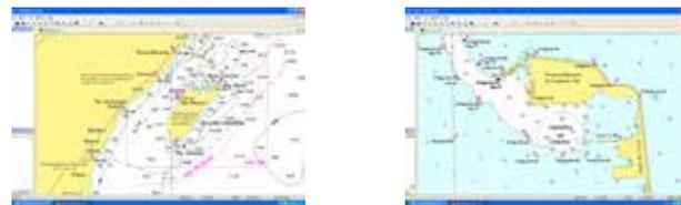
Normalmente, las RNC's se producen mediante el escaneo digital de los originales que se usan en el proceso de impresión multicolor. A diferencia de las ENC's, no existe un único formato aceptado para las RNC's. Los formatos principales son: Raster BSB (usado por México, EEUU, Canadá, Cuba, Argentina entre otros), y HCRF (usado por el Reino Unido, Australia, Nueva Zelanda, etc.).
