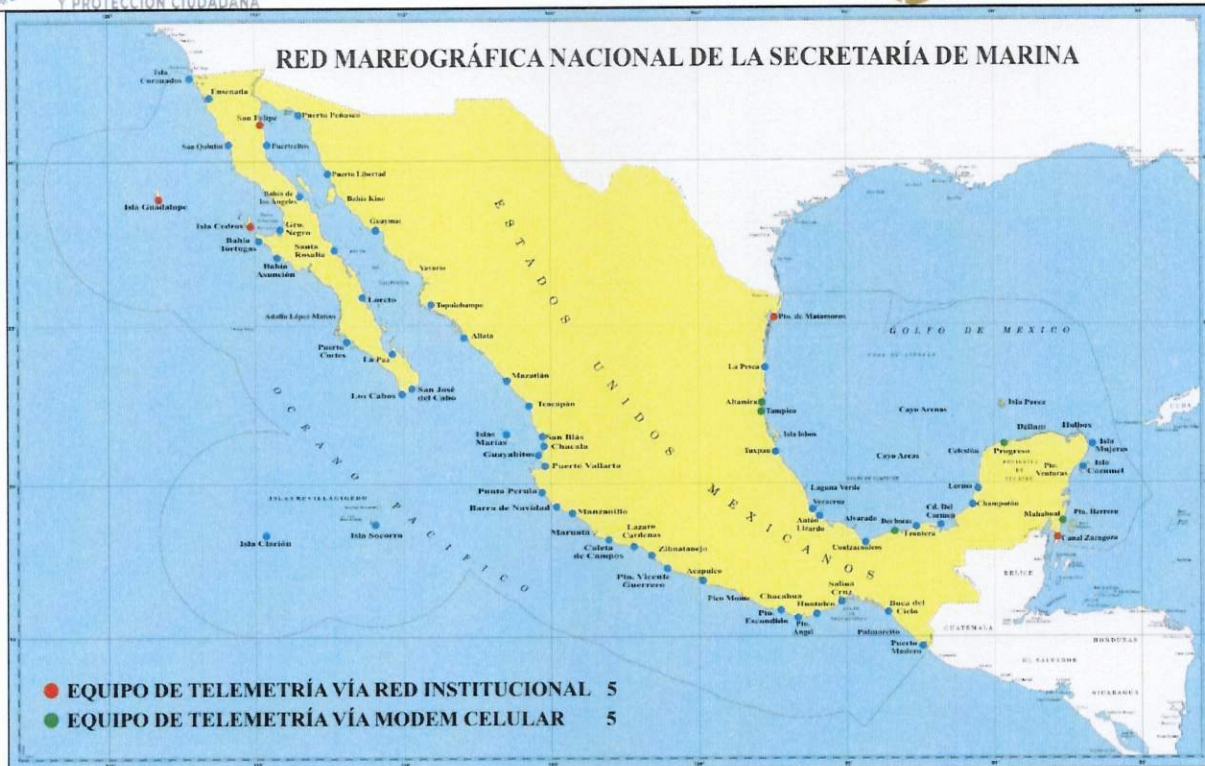
Figura 13. Ubicación de las 10 estaciones mareográficas que se les instalará equipo para la telemetrización cinco vía red institucional y cinco, vía modem celular.
